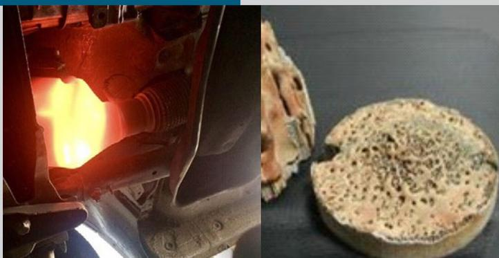
Диагностика режимов эксплуатации каталитических нейтрализаторов
