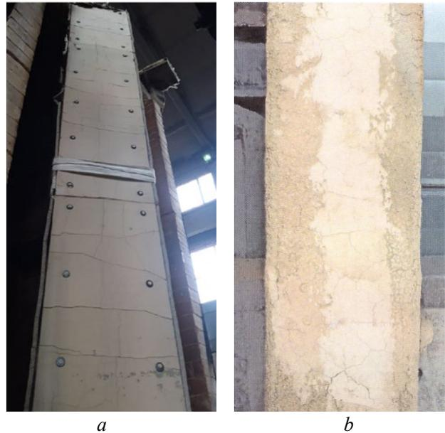
Рис. 3. Внешний вид образцов с огнезащитой плитами «ПРОЗАСК Файерпанель» (а) и штукатурка «ИГНИС ЛАЙТ» (б) после испытаний
