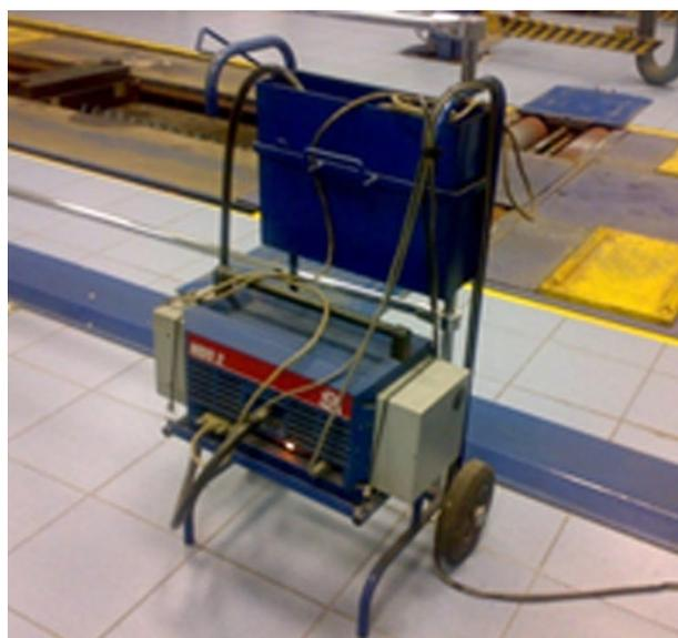
Рис. 4. Измеритель непрозрачности ОГ MDO2 фирмы МАХА
