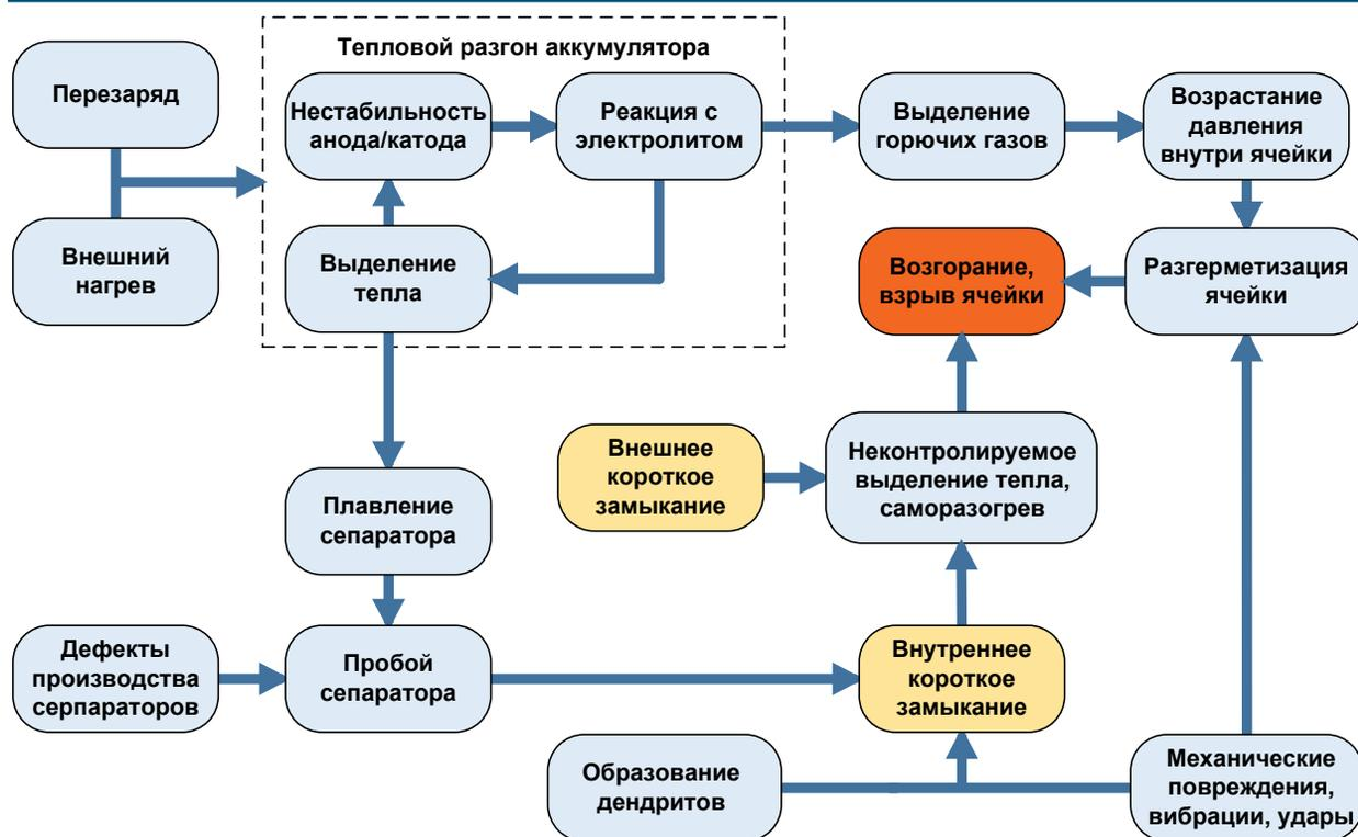
Рис. 3. Схема возможных причин возгорания литий-ионного аккумулятора
