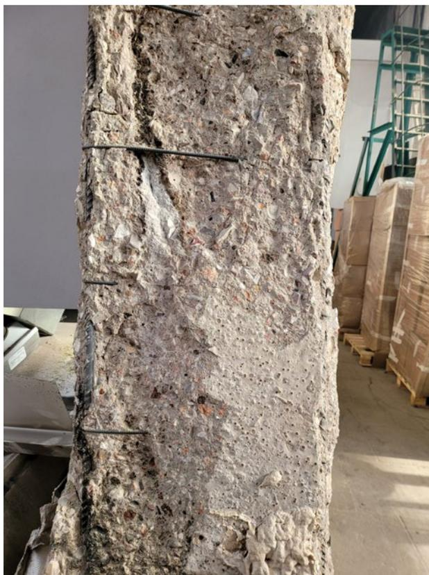
**Рис. 1.** Опытный образец после первого огневого эксперимента (без ППФ в составе бетона)
