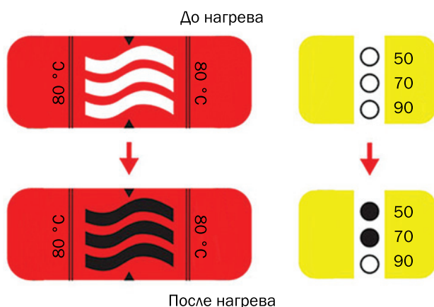
Рис. 1. Общий принцип действия индикаторных наклеек и стикеров
