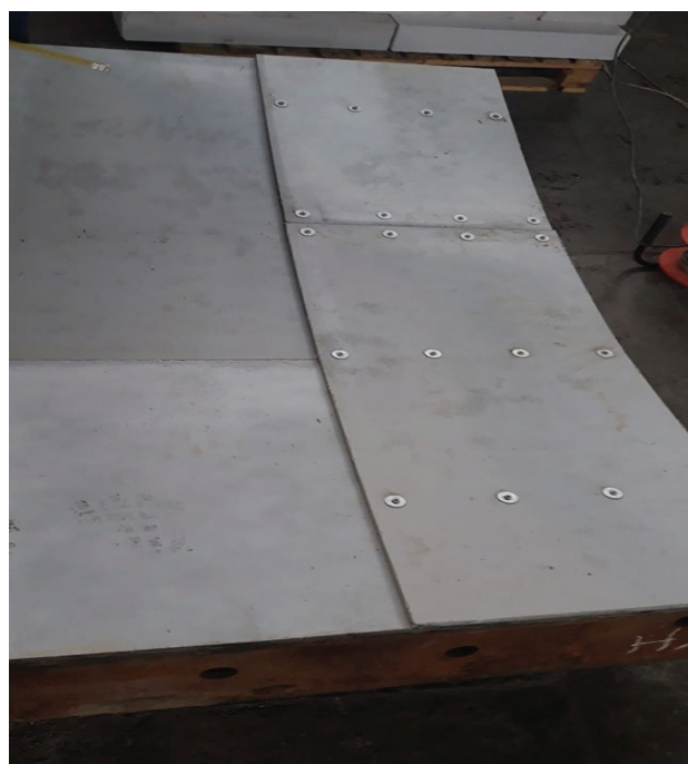
Рис. 3. Огнезащитные плиты смонтированы на чугунном тубинге
