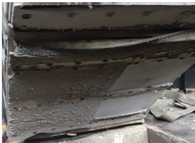
Рис. 5. Образец с огнезащитой после испытания (вид с обогреваемой стороны)
