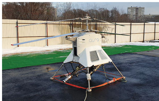
Рис. 4. Общий вид БВС с установкой импульсного пожаротушения IFEX
