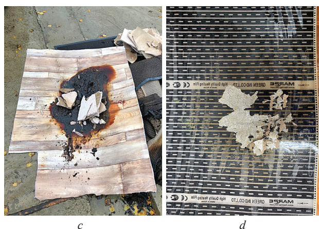
Рис. 17. Термические повреждения на изъятых с места происшествия образцах: на инфракрасной пленке ( a , b , d ) и на линолеуме ( c )
