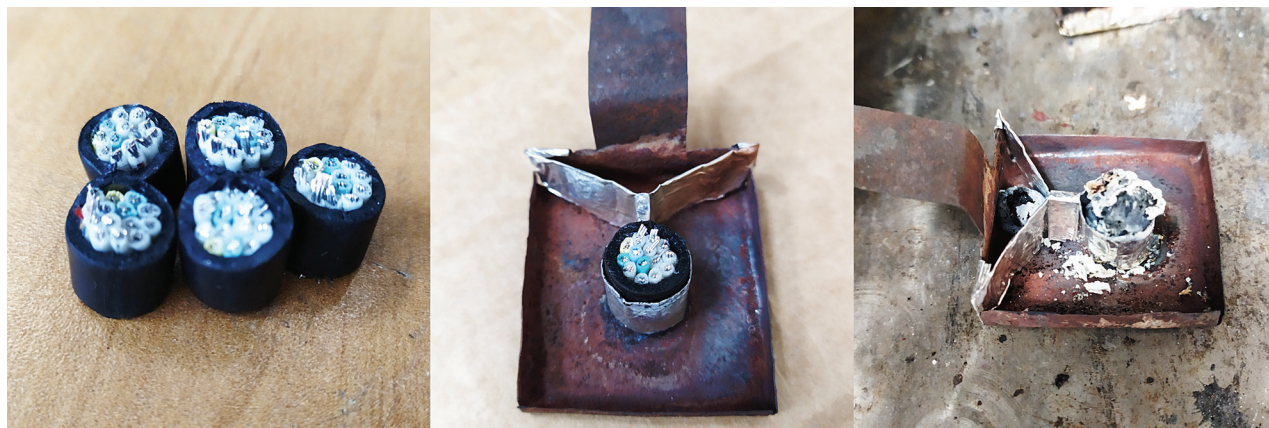
Рис. 3. Образцы кабеля ВВГнг для проведения огневых испытаний с площадью обогрева S_0 = 1 \text{ см}^2
