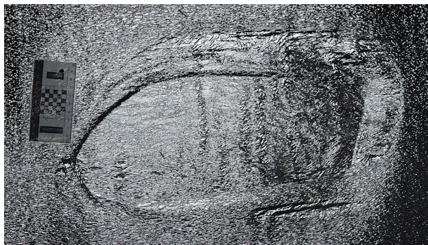
Рис. 14. Снимок расплавления фольгированного теплоизолятора
