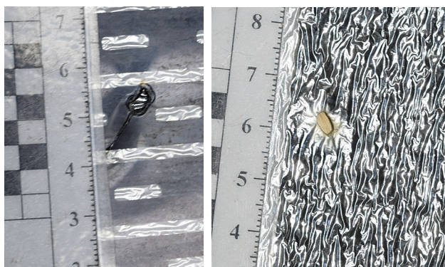
Рис. 15. Снимок локального расплавления ламинирующей пленки и нагревательного элемента, а также фольгированного теплоизолятора
