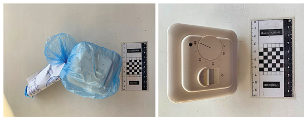
Рис. 18. Терморегулятор для пленочного нагревателя
