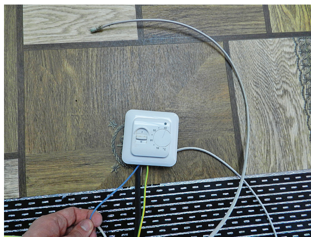
Рис. 10. Снимок терморегулятора экспериментальной установки
