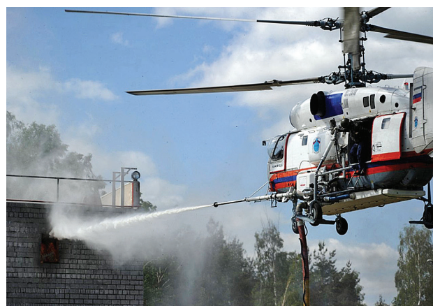
Рис. 2. Пример применения вертолета для тушения пожара в высотном здании с использованием вертикальной (а) и горизонтальной (б) подачи огнетушащего вещества
