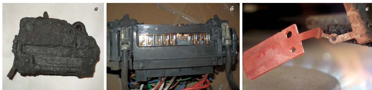
Рис. 1. Общий вид карбонизированного корпуса монтажного блока моторного отсека автомобиля Skoda Rapid (а), состояние плавких вставок предохранителей при вскрытом корпусе (б), фрагмент эксперимента по нагреванию плавкой вставки медного предохранителя (в)
