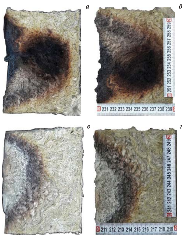
Рис. 8. Разрезы образцов минеральной ваты, поврежденных в результате точечного огневого воздействия на стальную обшивку, установленную без зазора: а, б — образец с проливом дизельного топлива с последующим тлением; в, г — сухой образец без последующего тления
