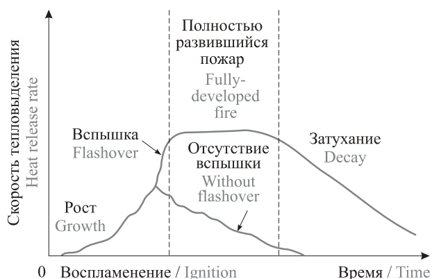
Рис. 2. Изменение мощности тепловыделения при неконтролируемом пожаре в помещении [9]
