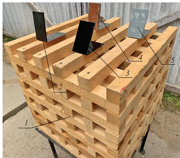
Рис. 2. Образцы твердых горючих материалов, закрепленные на модельном очаге пожара ранга 1А: 1 — модельный очаг пожара 1А; 2 — резина; 3 — окрашенная сталь; 4 — натуральная кожа; 5 — твердый пластик
