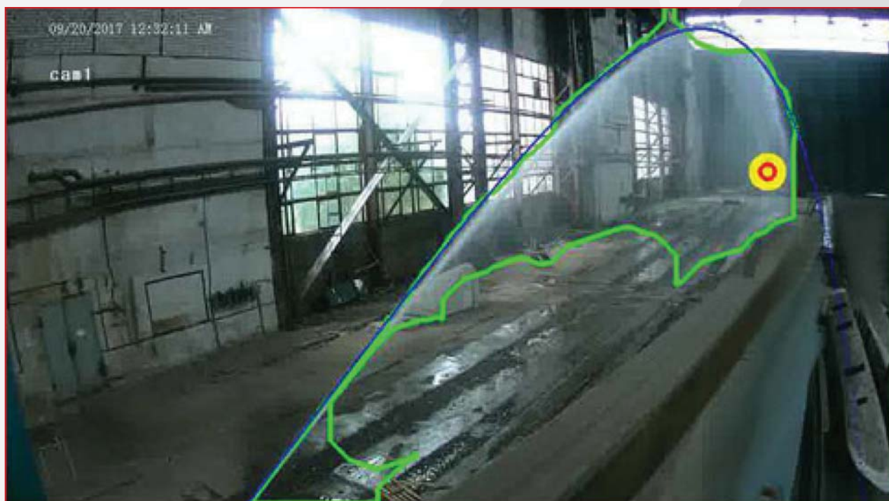
Рис. 7. Оцифрованный видеокادر с идентификацией потока жидкости
