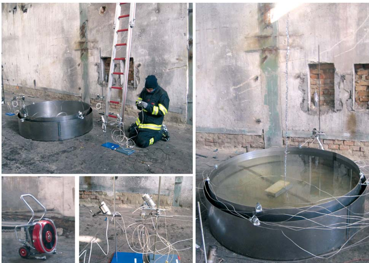
Рис. 4. Модель резервуара с защитной стенкой
