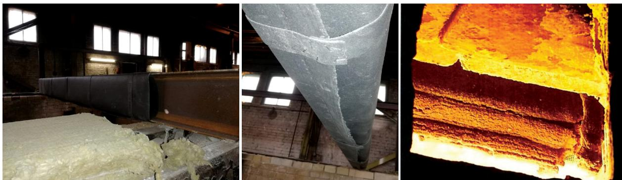
Рис. 7. Подготовка к испытаниям балки с огнезащитной изгибаемой сеткой и вид в смотровое окно на 5-й минуте испытания опытного образца № 1
