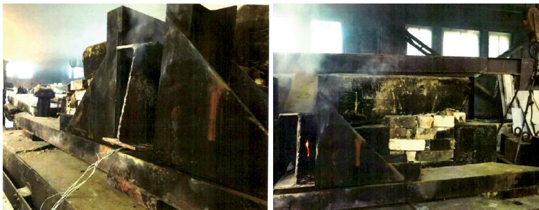
Рис. 9. Достижение опытными образцами № 1 (слева) и № 2 (справа) предельного состояния по несущей способности конструкции ( $R$ )
