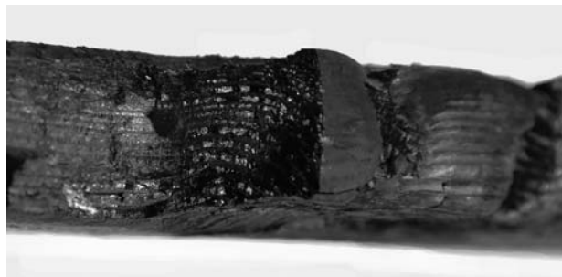
Рис. 5. Вид обугленного слоя древесины сосны после воздействия стандартного режима пожара
