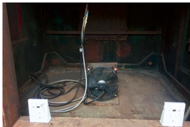
Рис. 4. Оборудование внутри камеры: вентилятор, кабели, шланги и устройство воспламенения Fig. 4. Equipment inside the chamber: fan, cables, hoses and ignition device
