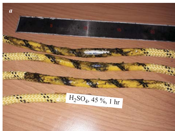
Рис. 7. Состояние оплетки образцов из полиамида с остаточной прочностью 20,69 % (а) и из полиэфира с остаточной прочностью 37,5 % (б) после воздействия H 2 SO 4 с концентрацией 45 % в течение 1 ч и последующего кондиционирования в течение 5 сут в нормальных климатических условиях
