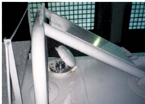
Рис. 2. Предохранительный клапан и дуги безопасности на цистерне
