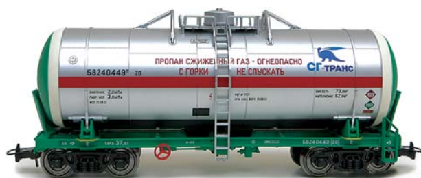
Рис. 3. Цистерна нового поколения для перевозки СУГ Fig. 3. New type of the railway tank for the LPG transportation
