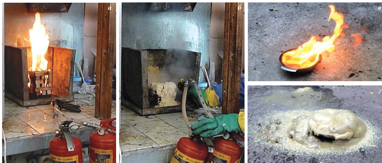
Рис. 4. Результаты тушения лабораторных очагов пожаров класса А (а, б) и класса В (в, г) до испытания (а, в) и после испытания (б, г) Fig. 4. The results of extinguishing a laboratory fire site with class A (a, b) and B (v, g) before the test (a, v) and after the test (b, g)
