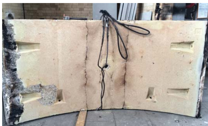
Рис. 5. Железобетонные тубинги после испытаний без добавки (а) и с добавкой полипропиленовой фибры (б)
