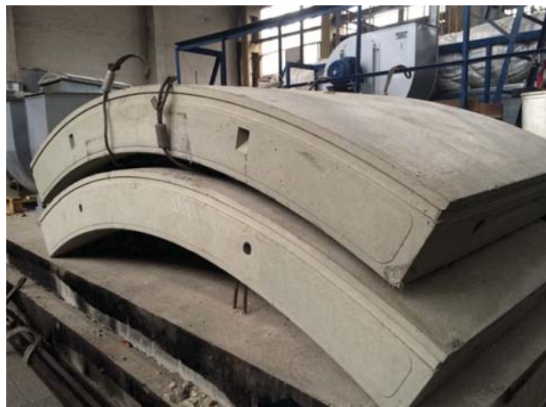
Рис. 1. Общий вид исследуемых железобетонных тубингов Fig. 1. General view of the tested reinforced concrete tubings
