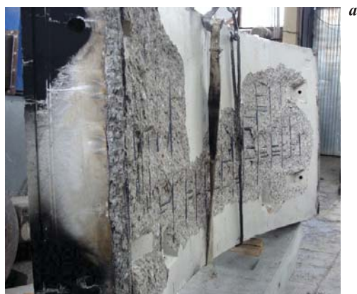
Рис. 5. Железобетонные тубинги после испытаний без добавки (а) и с добавкой полипропиленовой фибры (б)
