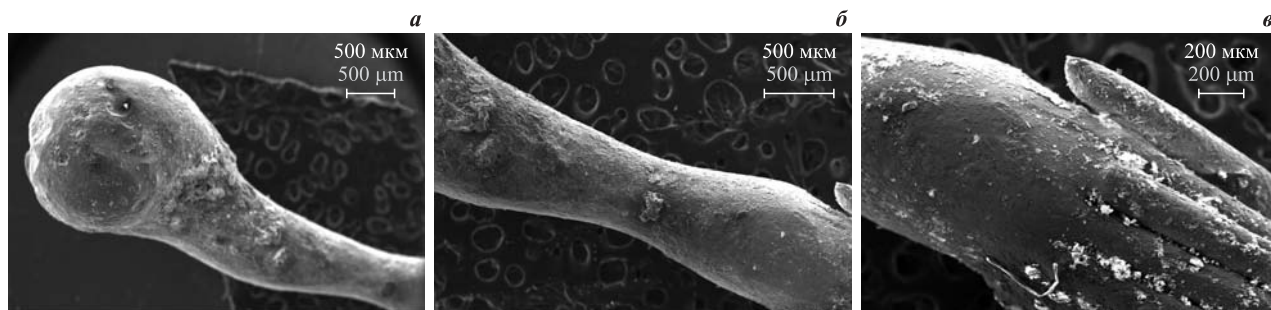
Рис. 2. Оплавление многопроволочного проводника: а — общий вид, увеличение 30\times ; б — утончения и утолщения, увеличение 43\times ; в — сплавление проволочек многопроволочного проводника, увеличение 70\times
