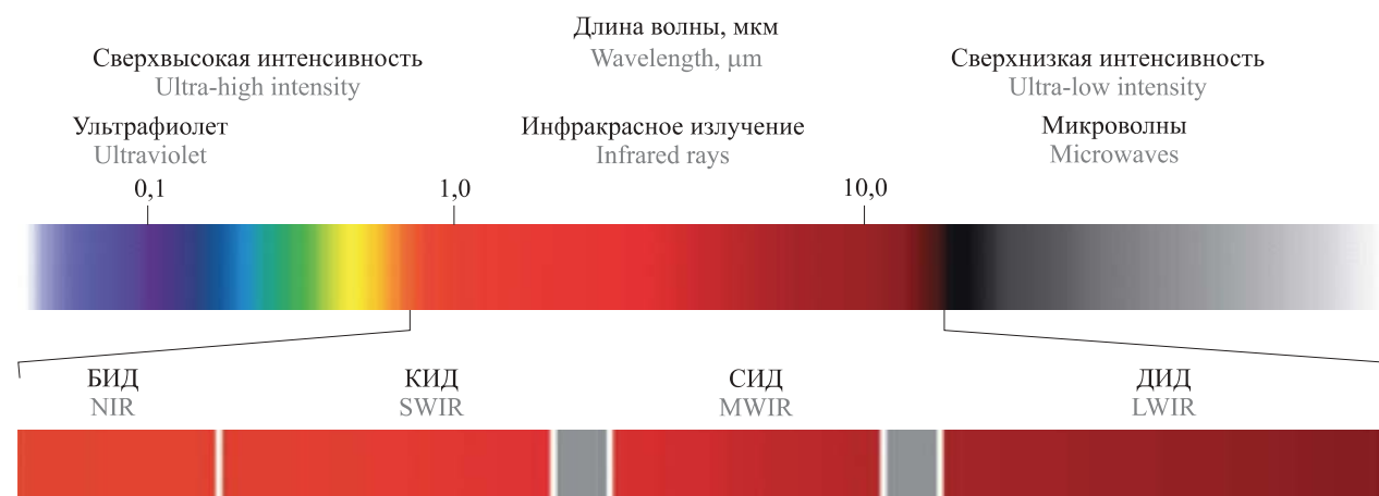
Рис. 2. Схема дифференциации электромагнитного светового спектра: БИД — ближний инфракрасный диапазон; КИД — коротковолновый инфракрасный диапазон; СИД — средневолновый инфракрасный диапазон; ДИД — длинноволновый инфракрасный диапазон
