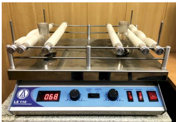
Рис. 4. Встряхивание измельченного образца с остатками инициатора горения
