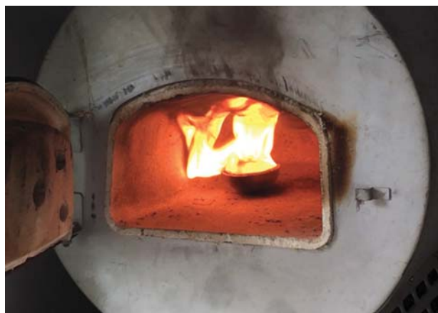
Рис. 13. Вспышка при нагревании полиуретана
