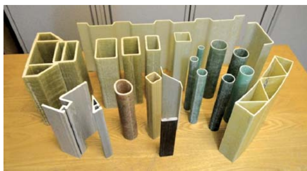
Рис. 1. Вид профилей из стеклопластика, изготовленных методом пултрузии Производственной компанией “Армопроект” Fig. 1. Appearance of fiberglass profiles made of pultrusion by Manufacturing Company “Armoproject”
