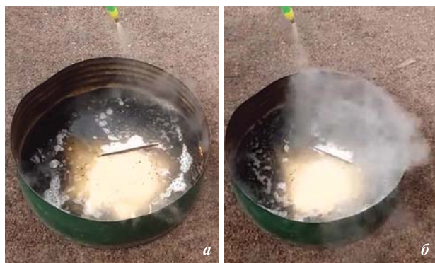
Рис. 6. Фрагменты процесса тушения бензина суспензиями DW с УНС: a — DW + MWCNT (0,01 % об.); б — DW + MWCNT (0,5 % об.)
