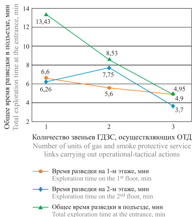
Рис. 3. Результаты опытов по проведению разведки на месте пожара в подъезде двухэтажного жилого здания V степени огнестойкости
