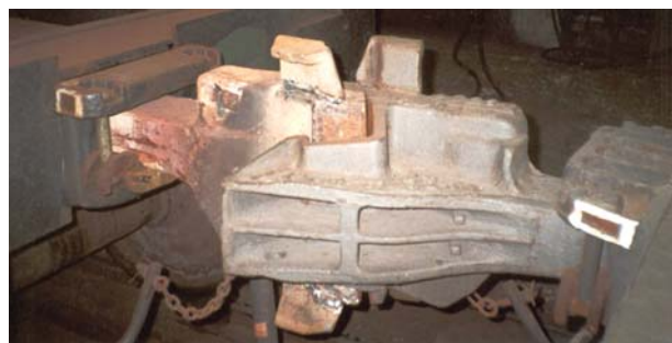
Рис. 6. Предохранитель от саморасцепки автосцепок
