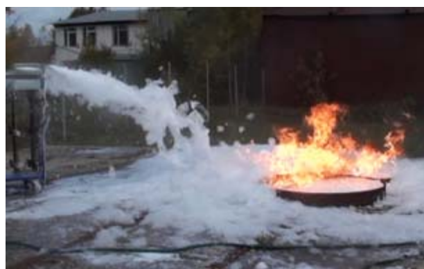
Рис. 3. Комплексный очаг, составленный из поддонов с гептаном
