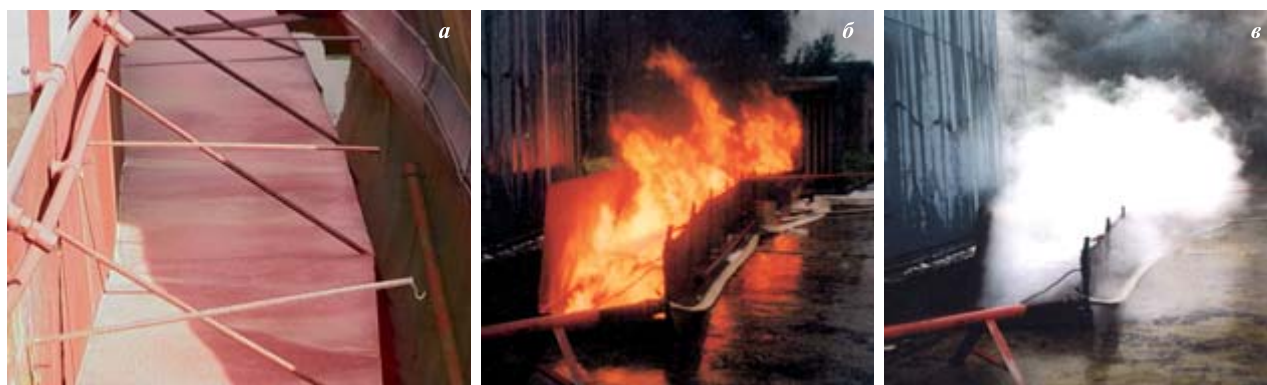
Рис. 1. Фрагменты тушения пламени нефтепродукта распыленными струями химически активного ингибитора: а — модель кольцевого затвора резервуара с плавающей крышей; б — модельный очаг горящей нефти, подготовленный для подачи хладона; в — ликвидация пламени
