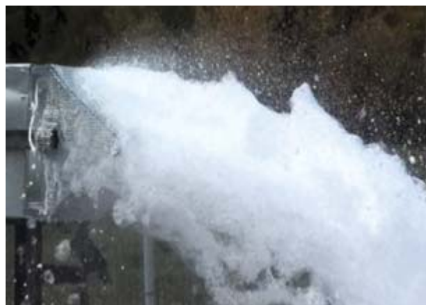
Рис. 1. Генератор пены высокой кратности со спиральным насадком, позволяющий получать пену полидисперсной структуры
