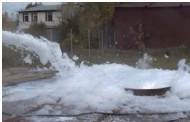
Рис. 4. Тушение пеной высокой кратности очага пожара, составленного из поддонов с н-гептаном
