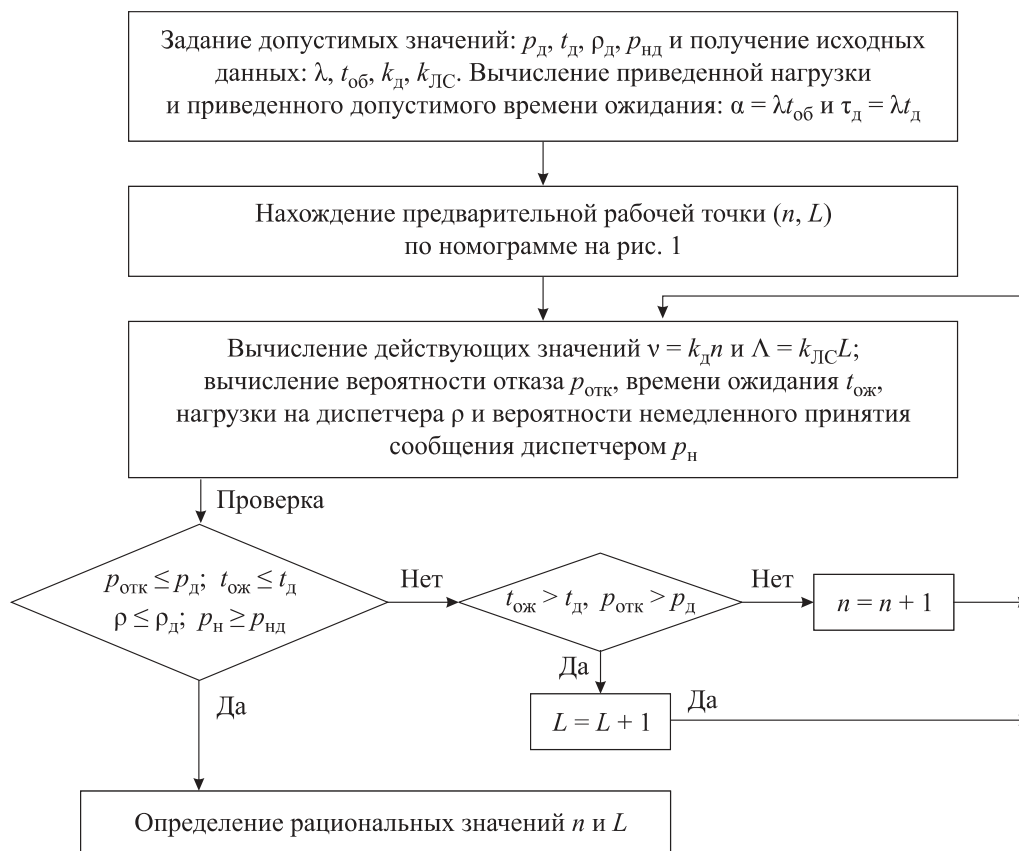
Рис. 2 Блок-схема определения числа диспетчеров и линий связи ДДС
