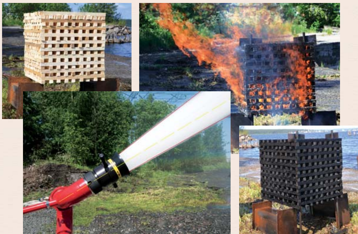
Рис. 6. Огневые испытания РУП на модельном очаге пожара класса А
