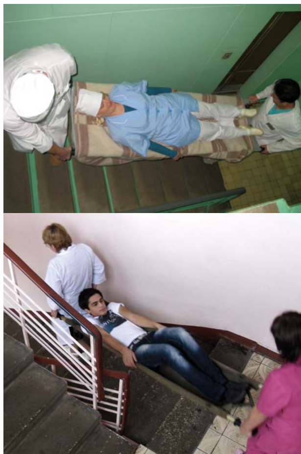
Рис. 4. Фрагменты проведения экспериментов по определению скорости переноски людей на носилках по лестнице вниз
