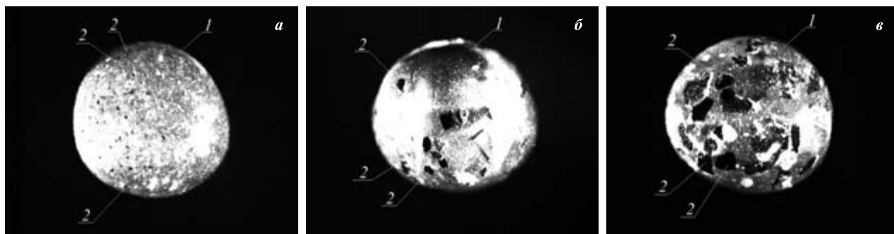
Рис. 2. Видеogramмы капель воды ( R_d = 3 мм) с включениями углеродистых частиц размером 50–70 мкм (а), 250–300 мкм (б), 450–500 мкм (в): 1 — капля; 2 — углеродистые частицы
