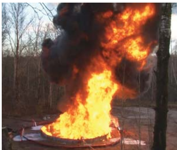
Рис. 6. Свободное горение СУГ на площади 100 \text{ м}^2 , высота пламени \sim 40 \text{ м}
