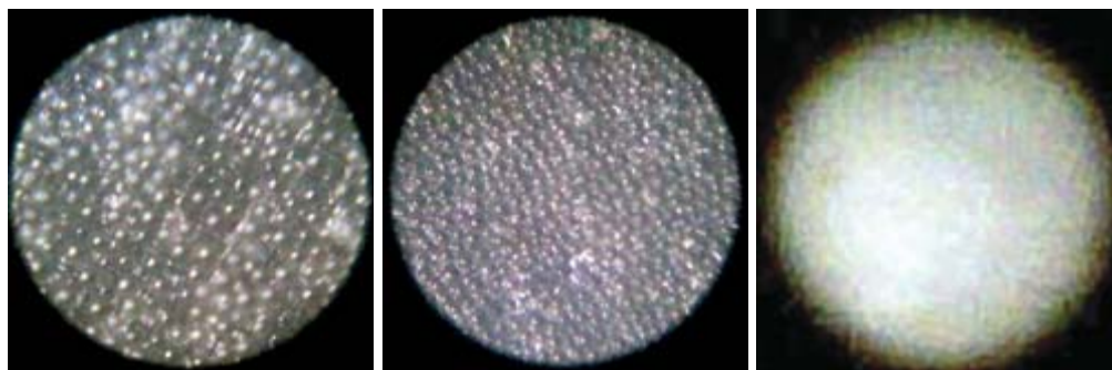
Рис. 2. Вид материалов с различной концентрацией стеклосфер под микроскопом
