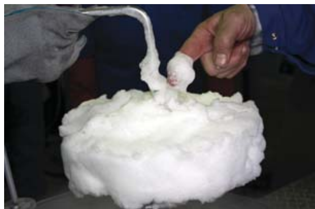
Рис. 3. Внутренняя (мокрая) часть слоя замороженной пены
