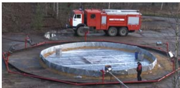
Рис. 4. Экспериментальный стенд ( S = 100 \text{ м}^2 , d = 11,2 \text{ м} )
