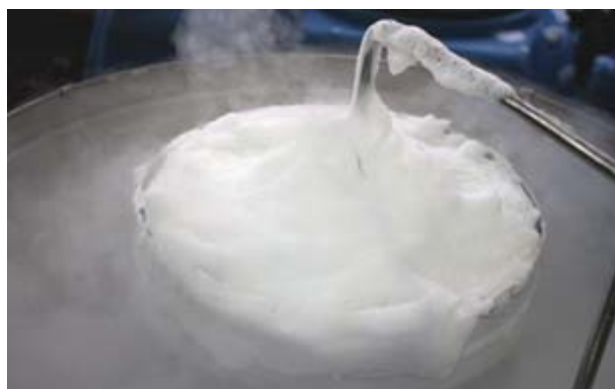
Рис. 1. Воздушно-механическая пена кратностью 50 на основе синтетического углеводородного пенообразователя в резервуаре с криогенной жидкостью (температура кипения минус 42 °С)
