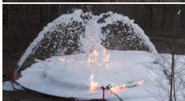
Рис. 7. Процесс тушения: а — начало подачи пены средней кратности (40–50); б — через 25 с; в — через 45 с; г — через 88 с (ликвидация горения в границах резервуара); д — полное прекращение горения на всей площади
