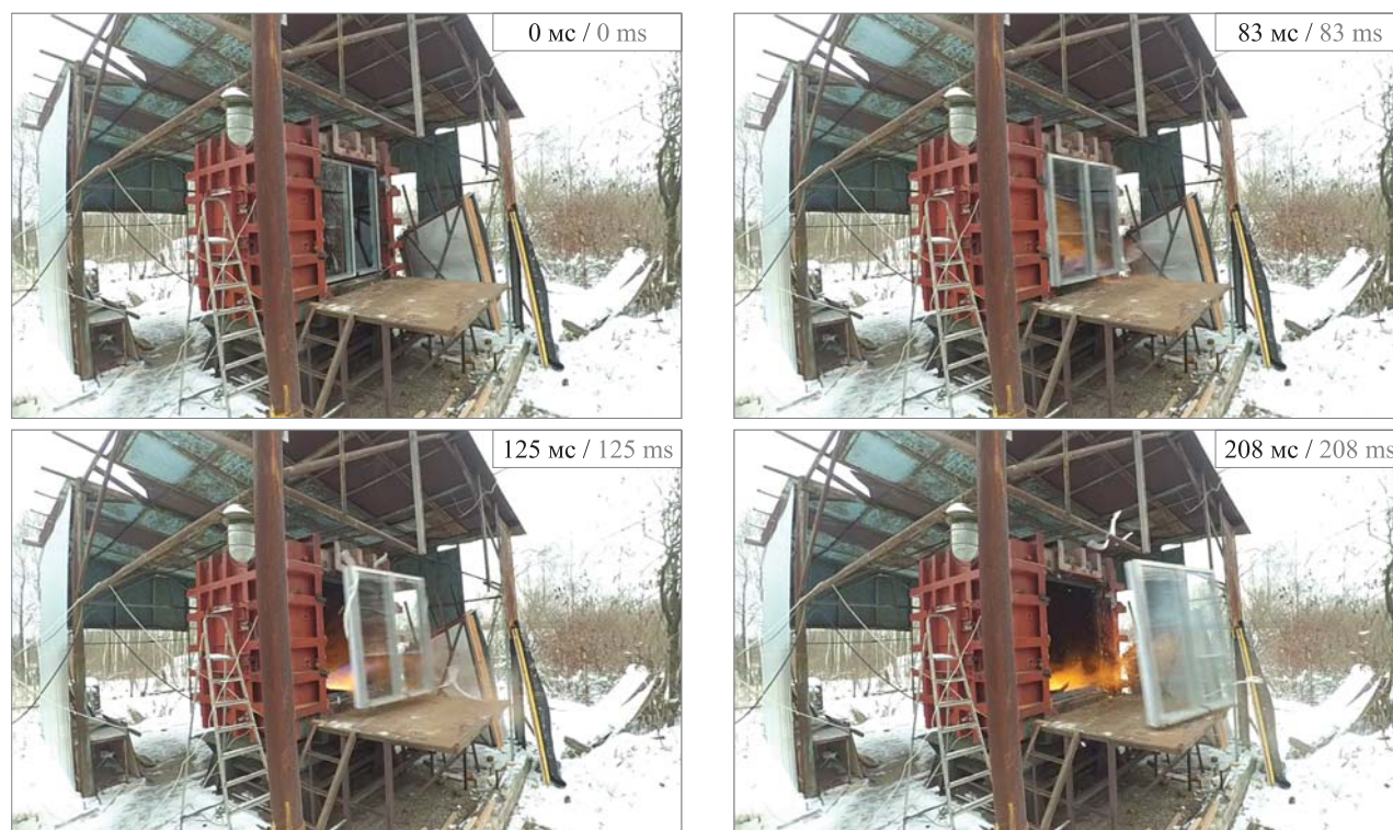
Рис. 10. Раскадровка взрыва в опытах со стеклопакетом
