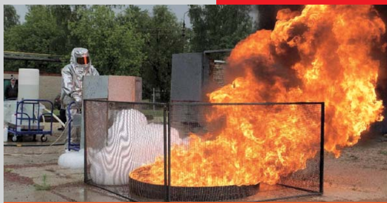
Тушение ГЖ пеной из пленкообразующих пенообразователей
