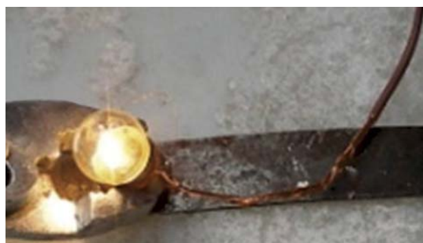
Рис. 3. Воздушный зазор, равный толщине изоляции провода, препятствует возникновению короткого замыкания в автомобильной электрической сети
