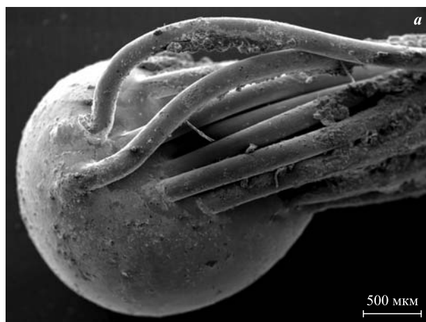
Рис. 2. Общий вид фрагментов медного проводника и стальной ленты, подвергшихся короткому замыканию: а — оплавление проводника при напряжении 24 В; б — разрушение проводника при напряжении 12 В; в — повреждение стальной ленты при перпендикулярном расположении проводника относительно ее поверхности; г — повреждение стальной ленты при касательном расположении проводника относительно ее поверхности
