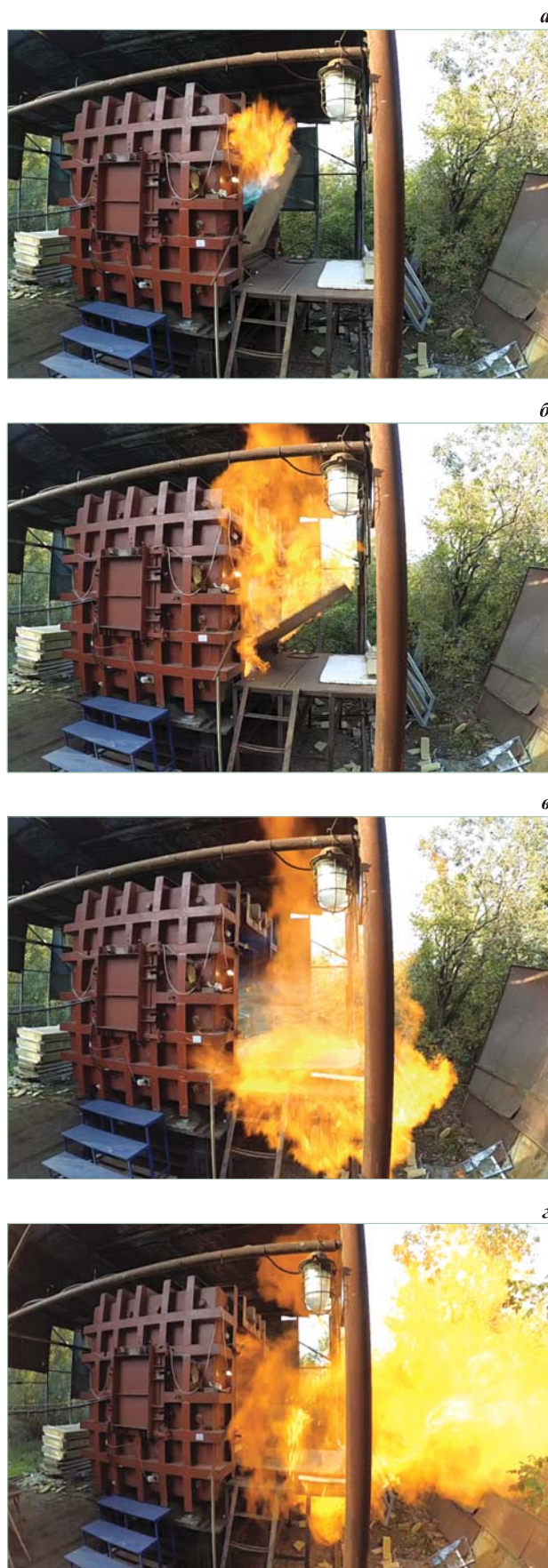
Рис. 2. Видеокadres взрыва при зажигании смеси в точке 2 в разные моменты времени от начала взрыва: а — 0,12 с; б — 0,20 с; в — 0,30 с; з — 0,70 с
