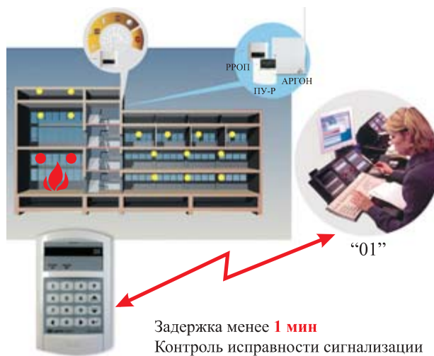
Рис. 1. Схема функционирования системы передачи информации о пожаре
