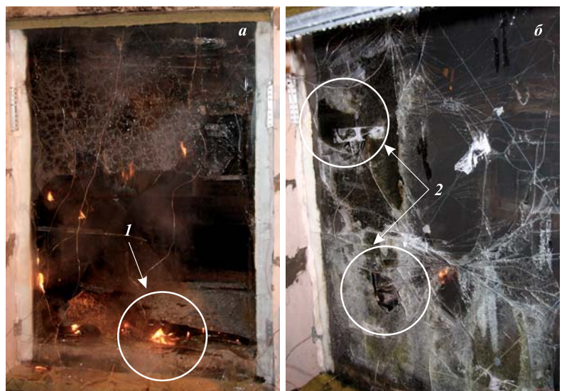
Рис. 5. Образец триплекса “3–1–3” после испытания: а — без водяного орошения; б — с водяным орошением; 1 — горящие фрагменты стекла; 2 — сквозные отверстия в образце
