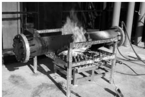
Рис. 16. Стенд для испытаний труб, изготовленных из композитных материалов [35–37]
