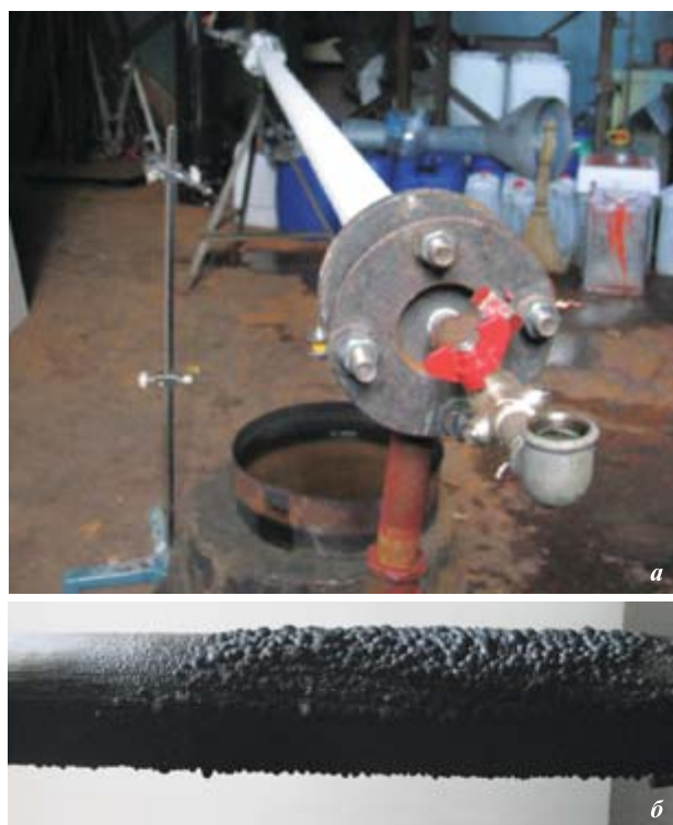
Рис. 12. Стенд для испытаний композитных труб (а) и состояние композитной трубы после испытаний (б)
