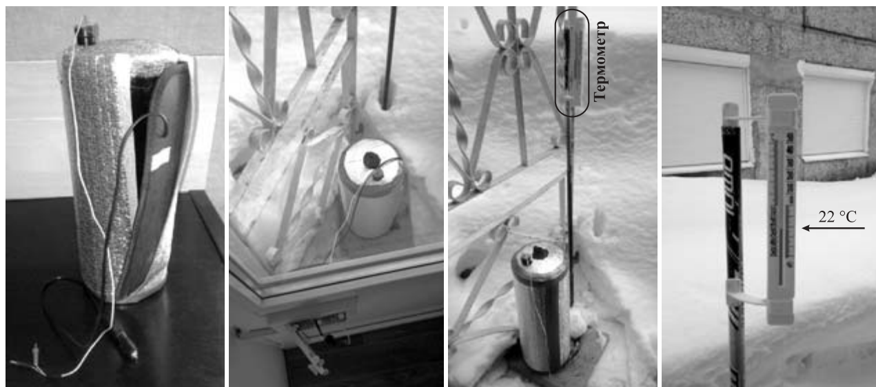
Рис. 3. Собранный образец и фрагменты проведения испытаний
