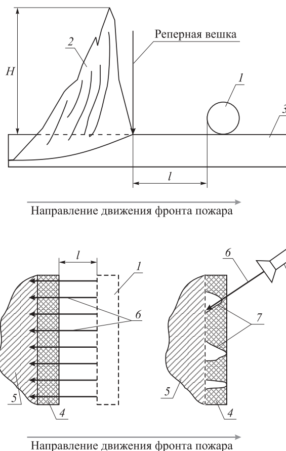
Рис. 3. Схема комбинированного способа локализации и тушения пожара: 1 — заряд ВВ; 2 — факел пламени; 3 — покров ПГМ; 4 — зона пиролиза; 5 — участок сгоревшего ПГМ; 6 — ударная волна; 7 — оставшиеся очаги пламени; 8 — дезинтегратор
