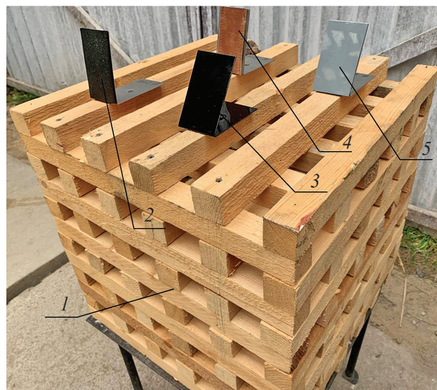
Рис. 2. Образцы твердых горючих материалов, закрепленные на модельном очаге пожара ранга 1А: 1 — модельный очаг пожара 1А; 2 — резина; 3 — окрашенная сталь; 4 — натуральная кожа; 5 — твердый пластик
