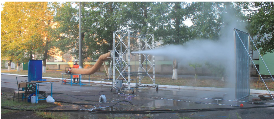
Рис. 2. Проведение измерений на опытно-экспериментальном стенде массива сопротивлений постоянному току при подаче струи температурно-активированной воды из дальнобойного пожарного ствола
