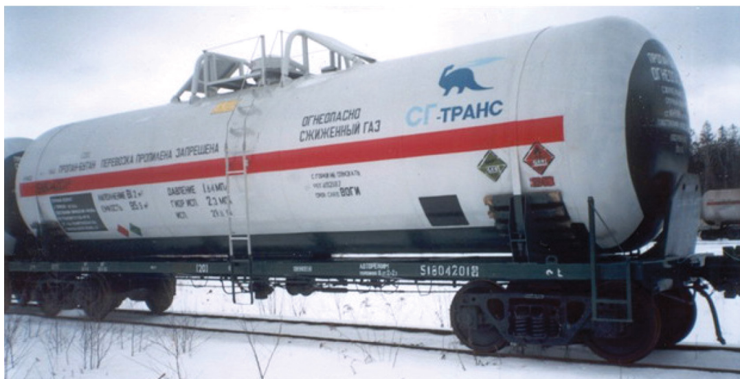
Цистерна модели 15-9503 АВП, оснащенная всеми разработанными средствами противопожарной защиты 15-9503 AVP tank model equipped with all recently developed fire protection means
