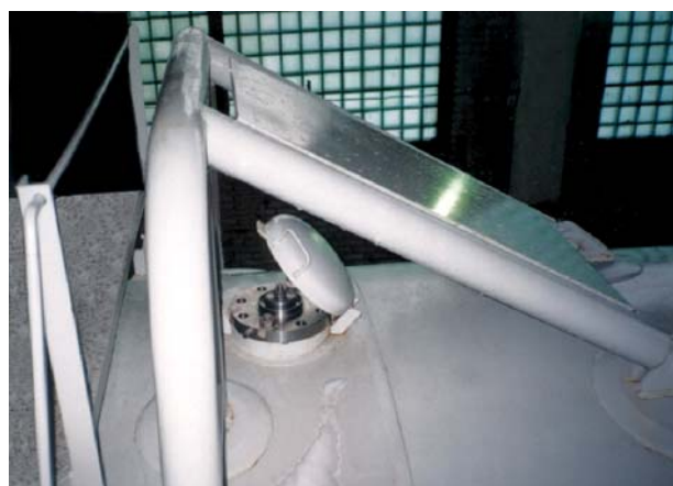
Рис. 2. Предохранительный клапан и дуги безопасности на цистерне
