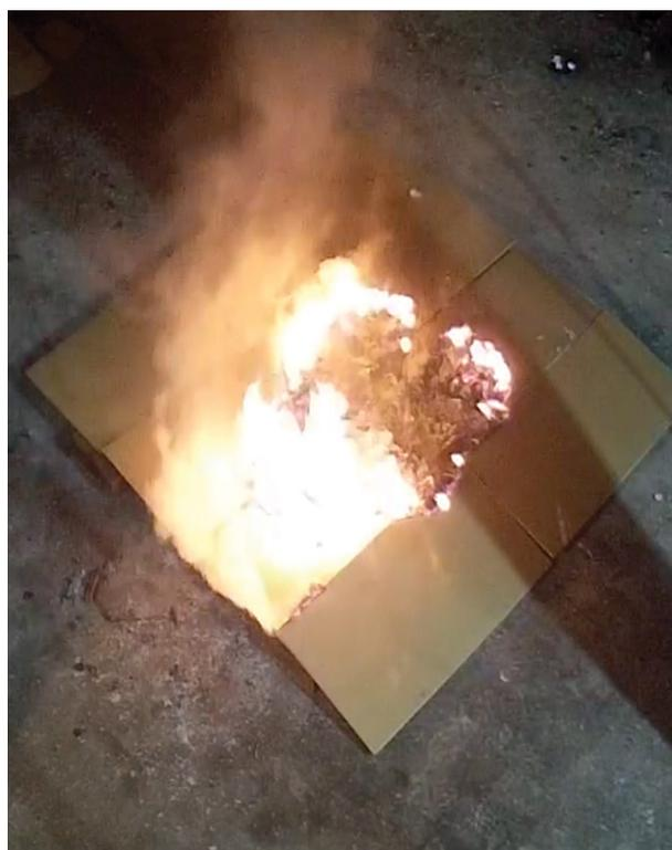
**Рис. 5.** Эксперимент по воспламенению пожарной нагрузки (картонных листов  $1,8 \times 1,8$  м) в испытательной лаборатории ВНИИПИИ
