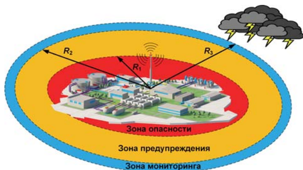
Пример распределения зон системы профилактической молниезащиты с применением локальных детекторов
