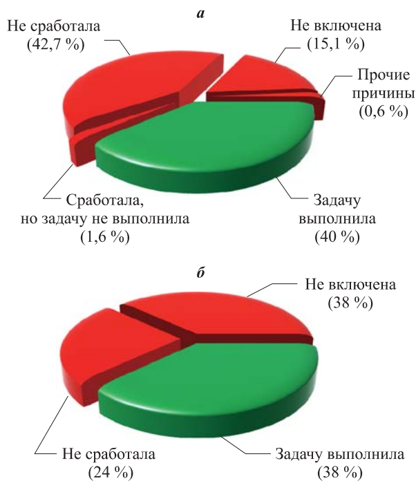
Рис. 7. Результаты сравнительного анализа степени работоспособности средств ПА при пожарах в жилых домах в России (а) и США (б)
