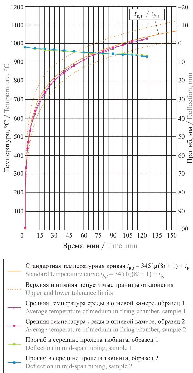
Рис. 3. Результаты испытаний на огнестойкость железобетонного тубинга с полипропиленовой фиброй
