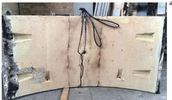
Рис. 5. Железобетонные тубинги после испытаний без добавки (а) и с добавкой полипропиленовой фибры (б)
