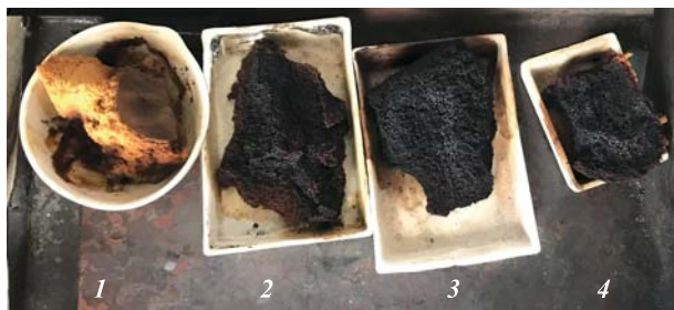
Рис. 3. Обугленные образцы полиуретана после обжига при t = 200\text{ }^{\circ}\text{C} в течение: 1 — 5 мин; 2 — 10 мин; 3 — 15 мин; 4 — 20 мин
