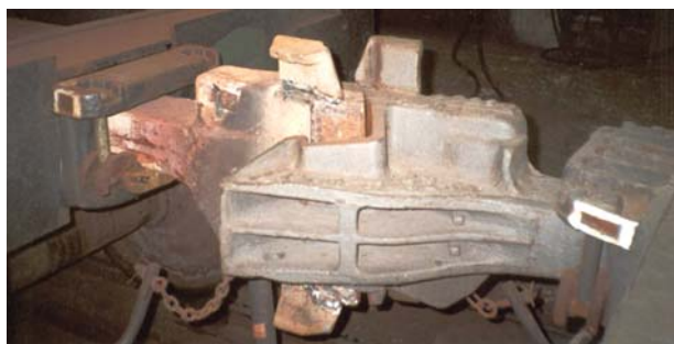
Рис. 6. Предохранитель от саморасцепки автосцепок
