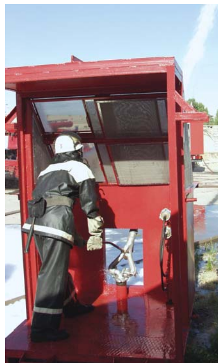
Рис. 2. Теплозащитный экран “СОГДА-4” со встроенным лафетным стволом ПЛС-20
