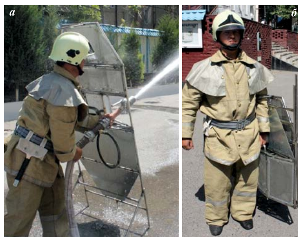
Рис. 4. Теплозащитный экран “СОГДА-1В” в развернутом, боевом положении (а) и в свернутом состоянии (б)
