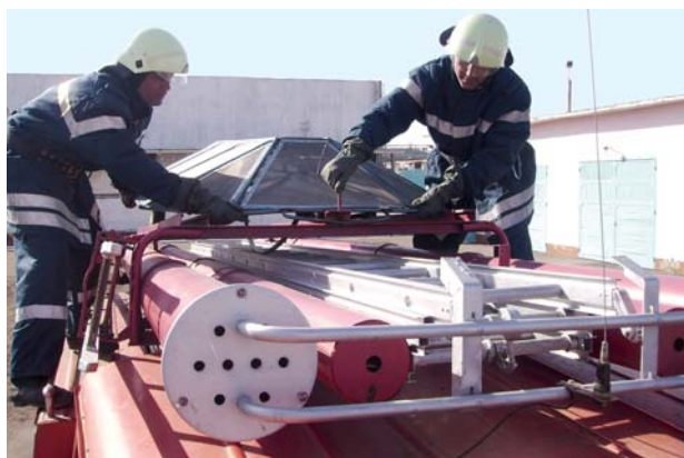
Рис. 6. Крепления для перевозки экранов “СОГДА-1А” на АЦ-40
