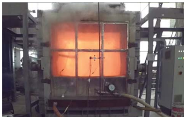
Рис. 3. Фрагмент испытания образца противопожарной преграды “СОГДА” (модель 1) в малогабаритной печи
