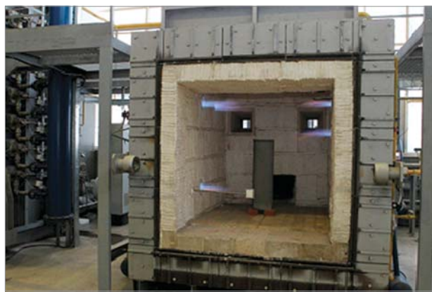
Рис. 2. Общий вид экспериментальной установки — малогабаритной печи для испытания строительных конструкций на огнестойкость
