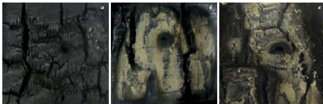
Рис. 3. Вид поверхности образцов древесины после огневых испытаний в маломасштабной установке: а — современной (Архангельская обл.); б — элементы деревянного перекрытия (1890 г.), театр кукол “Гулливёр”, г. Курган; в — церковь Николая Чудотворца (1865 г.), Брянская обл.
