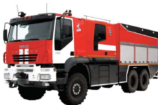
Рис. 6. Пожарно-спасательный автомобиль в климатическом исполнении ХЛ ПСА-С-6,0-40(6339)
