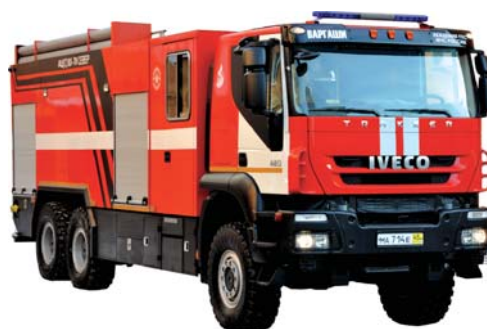
Рис. 7. Пожарная автоцистерна в климатическом исполнении ХЛ АЦ-С-8,0-70(6339)
