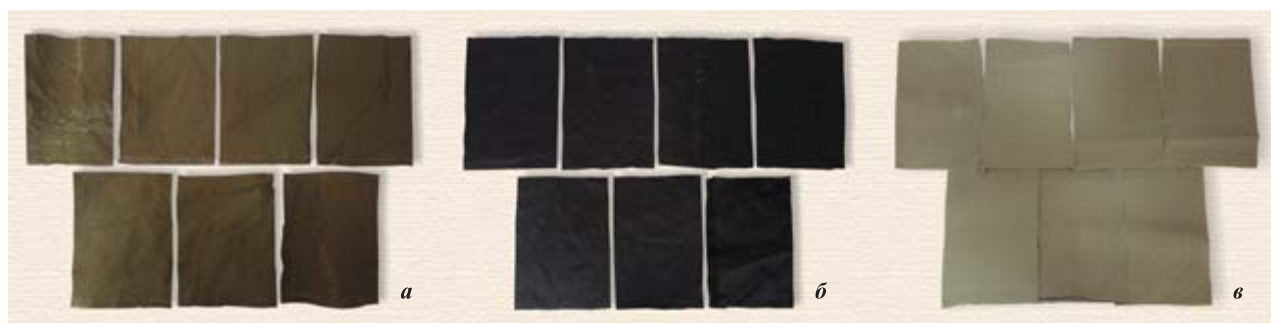
Рис. 5. Вид образцов тканей перед испытаниями: а — хлопковая ткань, обработанная антипиренами; б — полиэстер; в — хлопковая ткань без обработки
