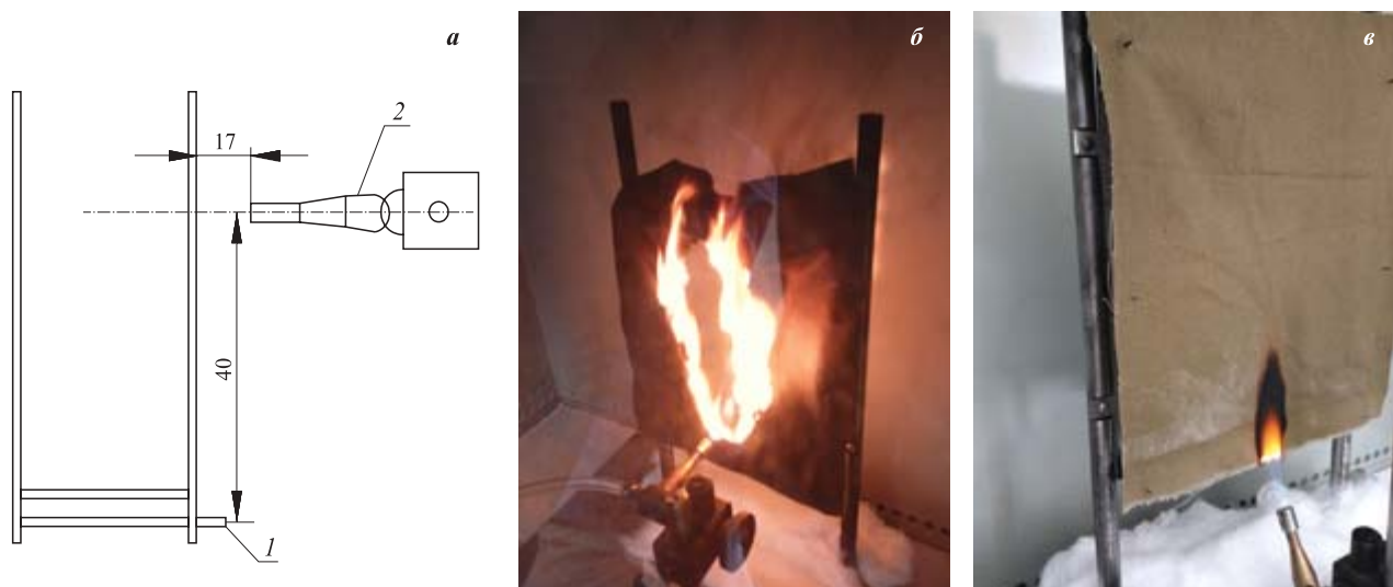
Рис. 2. Схема установки газовой горелки (а) и ее положение в процессе испытаний тканей на воспламеняемость — прямое (б) и с наклоном 60° (в): 1 — рамка; 2 — газовая горелка
