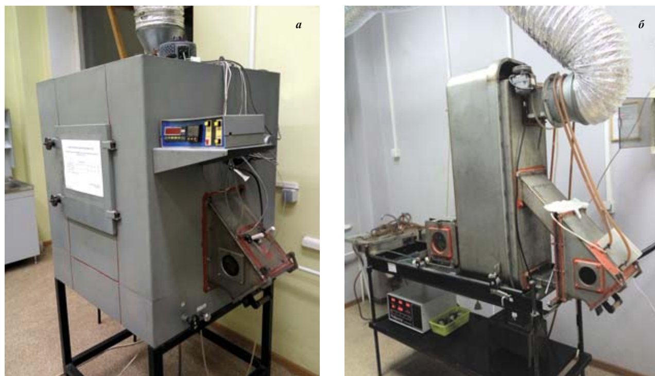
Рис. 3. Общий вид установок по определению коэффициента дымообразования (а) и токсичности (б)
