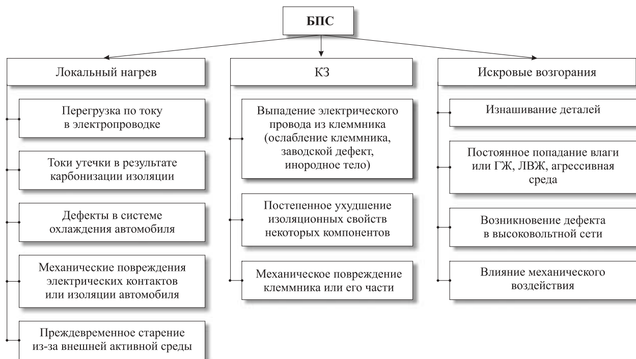
Рис. 3. Аварийные режимы, связанные с возникновением БПС в электросети автомобиля
