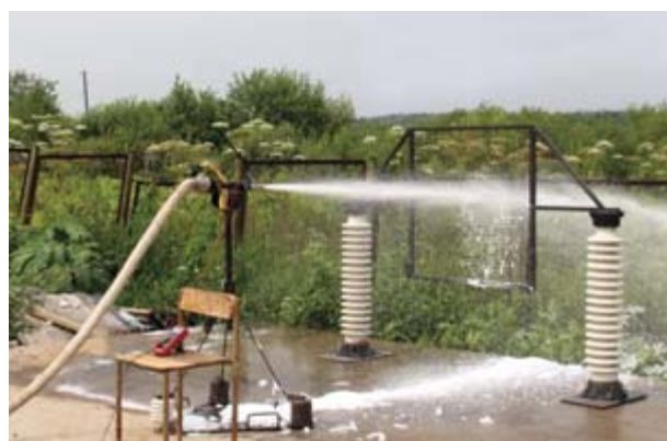
Рис. 2. Эксперимент по оценке возможности применения компрессионной пены для тушения электрооборудования под напряжением
