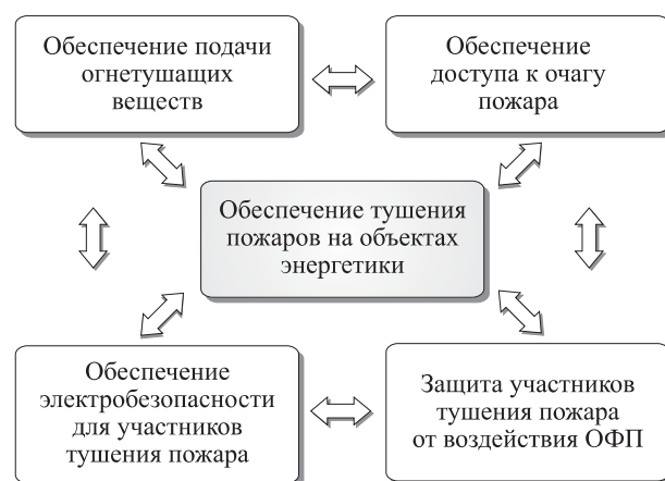
Рис. 3. Схема обеспечения тушения пожара на объекте энергетики
