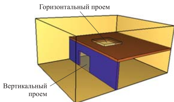
Рис. 7. Вертикальный и горизонтальный проемы
